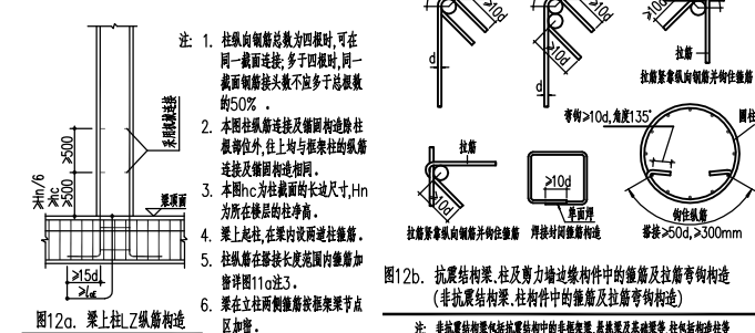
图12a. 梁上柱纵筋构造
